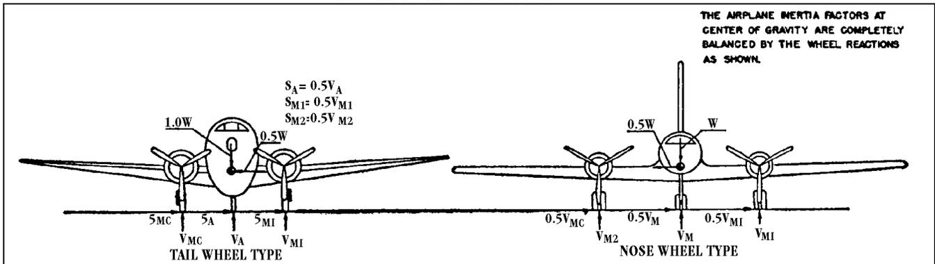
FIGURE 4b-13—Ground turning
